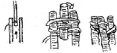
Hecho ésto, se anuda un chicote del cebo en una de las patas exteriores y sin azocar, se tejen tres vueltas, para terminar haciendo firme el otro chicote en la misma pata inicial con la vuelta apropiada. Al elevar la cabeza del trípode, la pata central se abate, retorciendo el cabo, y quedando muy seguro el amarre una vez que las patas se afirman al terreno.
