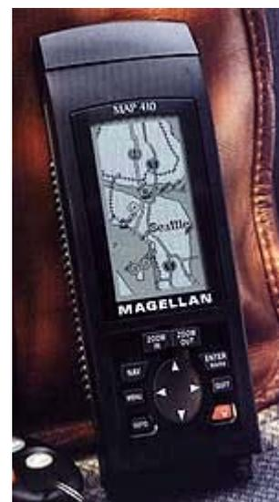
Algunos receptores tienen la antena receptora interna integrada en la parte superior de la carcasa, y otros tienen una pequeña antena exterior desmontable que puede moverse a una posición cercana para tener una mejor recepción de los satélites (se puede llevar el receptor GPS en un bolsillo o en la mochila funcionando con la antena sujeta al casco o alguna parte exterior de la mochila, etc.). Algunos otros admiten una antena exterior opcional.
